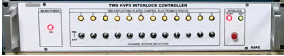
Fig. 3.29 TWD HVPS Interlock Module
