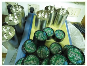
Fig. 4 : PMT Bases
